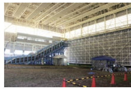
研究棟内に設置された実験設備と、天井には544個の噴霧器が装着されています
