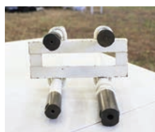
ある4本のノズルがあり、異なる降雨量によって噴霧するノズルが異なります
